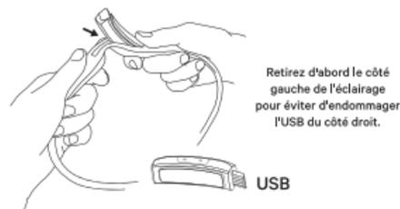
Retirez d'abord le côté gauche de l'éclairage pour éviter d'endommager l'USB du côté droit.
